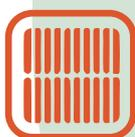
Tecnologia Super Multi BusBar con ribbon cilindrici: Minore distanza tra ribbon e finger più corti a garanzia di maggiore potenza utile in uscita. Saldatura di precisione dei ribbon evita micro-cracks sulle celle.
